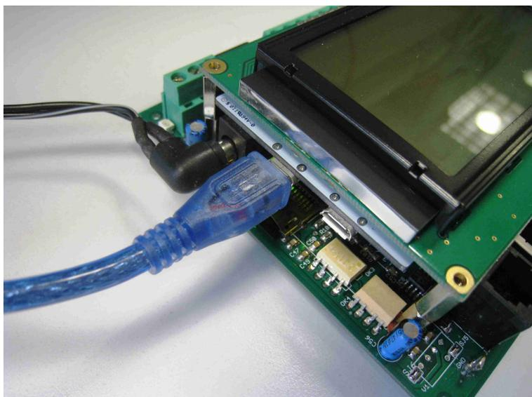
La programmazione fisica si effettua come per un "normale" ARDUINO tramite USB collegata ad un PC.
